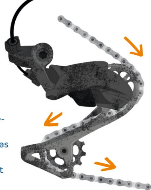
Läuft die Kette nicht sauber über die Ritzel oder fühlen sich einzelne Gänge hakelig an, hat sich vielleicht die Kabelspannung verringert. Bei Kettenschaltungen kann mit der Schraube am Schalthebel, aus der der Seilzug austritt, die Spannung angepasst werden. Hilft das nicht, ist vielleicht Verschleiß die Ursache. Dann sollte das Rad in der Fahrradwerkstatt repariert werden.
